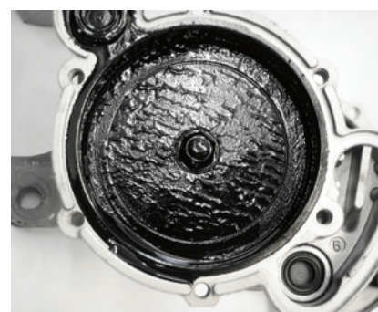
Fig. 3: El lodo de aceite en la bomba de vacío del VW Transporter produce ruidos de tableteo
